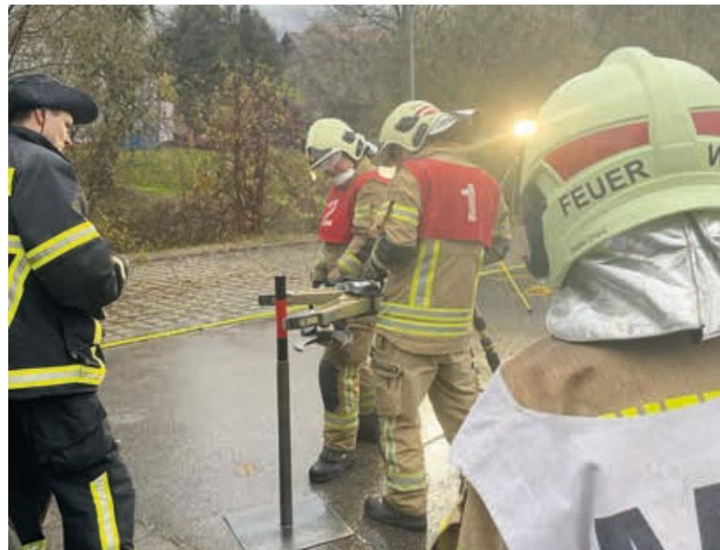
Das Stahlrohr muss vom R-TR mit Spreizer und Schere bearbeitet werden.
