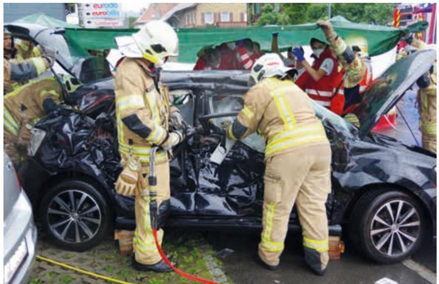
Beim Fahrzeug mussten die Türen mit hydraulischem Rettungsgerät geöffnet werden.
