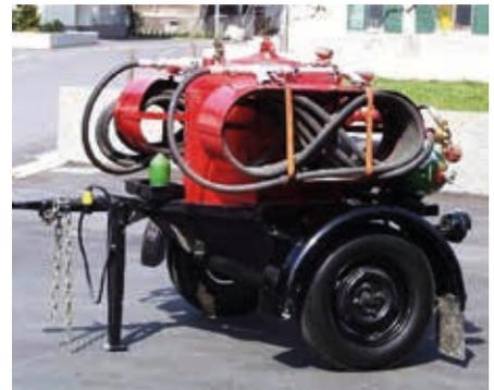
Pulverlöschanhänger, Minimax, 250 kg Löschpulver, Baujahr 1963
